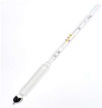
注) ボーメ比重計には重ボーメ度と軽ボーメ度があり、水より重い食塩水は重ボーメ度で計測します。
