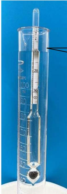
透明な筒状の入れ物(メスシリンダーなど)に水道水をボーメ比重計が浮く程度に注ぎ、ボーメ比重計を浮かべます。
