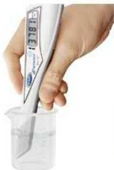
先端のセンサー部分を食塩水に浸けます
