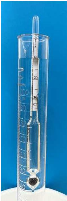
透明な筒状の入れ物 (メスシリンダーなど) に食塩水をボーメ比重計が浮く程度に注ぎ、ボーメ比重計を浮かべます
